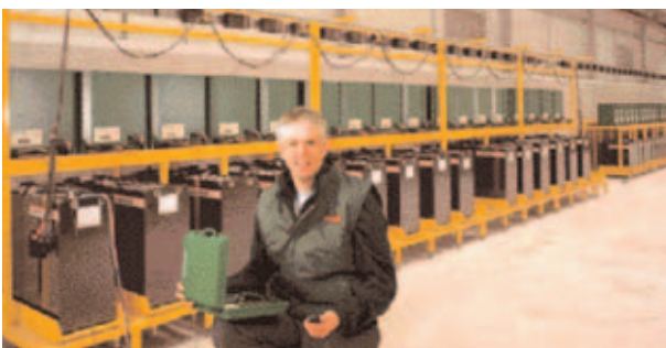
Het uitwisselen van de geheugedata met PC in een batterij laadstation
