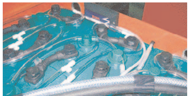
De BIM blijft permanent op de tractiebatterij gemonteerd
