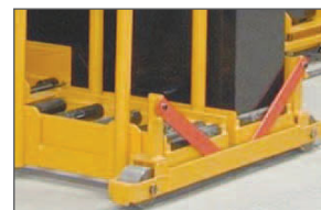
Reteszeléses rögzítés a biztonságos szállítás érdekében
