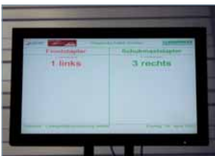
trak® monitor: Der Fahrer erhält einen Hinweis auf die nächste vollgeladene Batterie.
