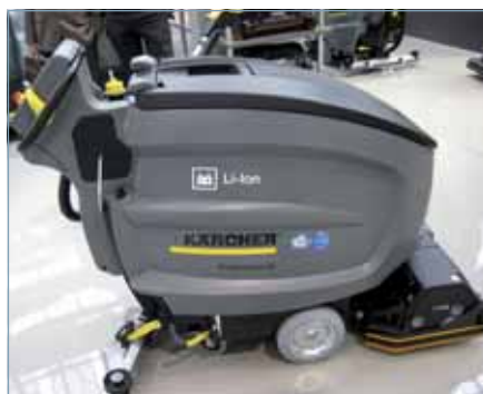
Kärcher Reinigungsmaschine, ausgestattet mit 3 Lithium-Ionen Modulen von HOPPECKE.
