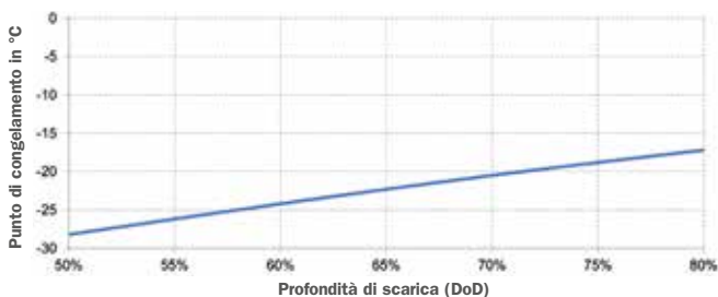
Fig. 7-11: Punto di congelamento dell'elettrolita in funzione della profondità di scarica (DoD)
