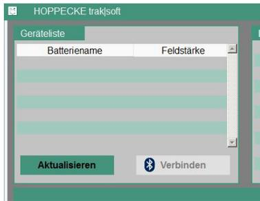
**Aktualisieren** starten Sie die Funkverbindung und das Programm sucht im gesamten Empfangsbereich nach Batteriecontrollern. Die verfügbaren Geräte werden in der Liste mit ihrem Batterienamen und der Sendefeldstärke angezeigt. Das Programm sortiert das Empfang stärkste Gerät nach oben. Somit wird die Batterie mit trak | collect in Ihrer unmittelbaren Umgebung als erste in der Liste aufgeführt.
