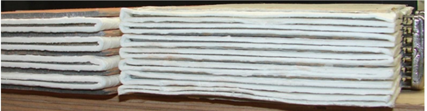
Abbildung 2: Vergleich Plattenstapel AGM (klassisch) vs. Reinblei-Design (grid | Xtreme VR) bei gleichem Volumen
