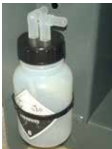
Illustration 7: Collecteur de condensation fixé sur le porteur
