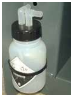
Immagine 7: Separatore di condensa fissato al supporto
