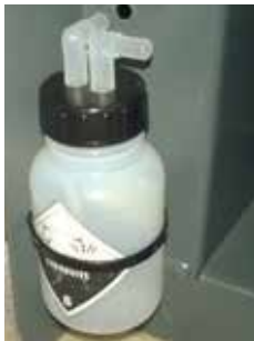
Afbeelding 7: Condensafscheider bevestigd op de drager
